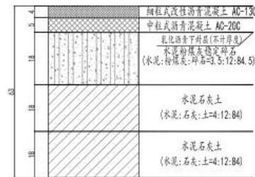
图3 项目机动车道路面结构（1:10）
